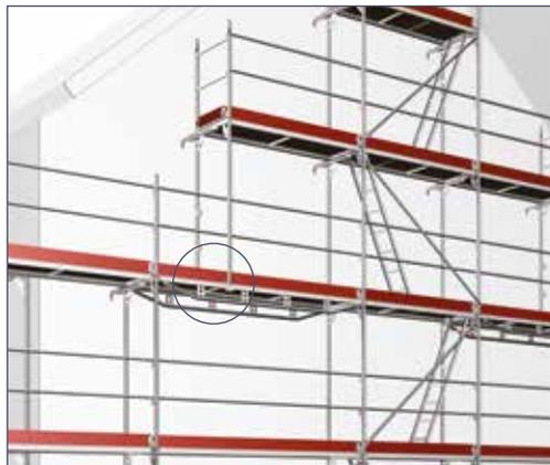
Con el **Reductor de travesaño de 1,09 m. a 0,73 m. 5** se puede reducir el ancho del andamio de 1,09 m. a 0,73 m. Así, se pueden usar marcos de 70 en una subestructura de un metro de ancho.
