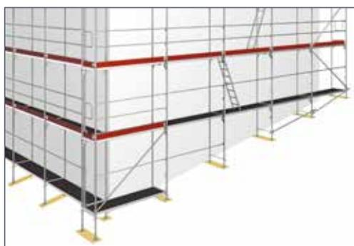
El andamiaje puede adaptarse a las condiciones particulares del terreno mediante marcos de 0,66 - 1,0 y 1,5 m. El ensamblaje siempre se comenzará desde el punto más elevado. El marco de 1,5 x 1,09 m. tiene dos cajetines para barandillas de seguridad, lo que lo hace idóneo para su uso en andamiajes para fachadas.
