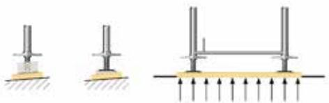
Las roscas de todas las bases de Layher tienen un diámetro exterior de 38 mm. El diámetro exterior de la palometa de la base es de 205 mm. Las dimensiones de la placas base son de 150 x 150 mm.
