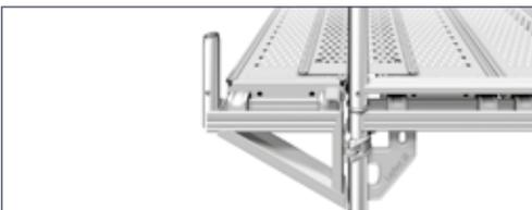
La **Lámina cubre huecos 10** se utiliza para cubrir huecos de hasta 13 cm. de ancho propios del andamiaje. Debe asegurarse con pasadores para plataforma.
