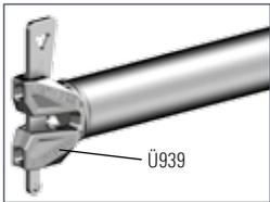
El andamio tiene que estar vertical y paralelamente arriostrado a la fachada, a tracción y a empuje. El **Ancaje Allround 13** tiene que sujetarse mediante una grapa al vertical y apoyada con la chapa de horquilla en el perfil en "U" de la horizontal en "U".
