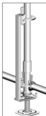
Fijación de la base y collarín con vertical mediante la **Pieza de unión base vertical 6**.
