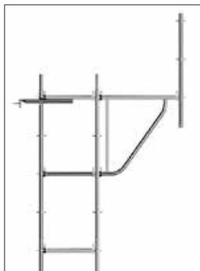
La **Ménsula en "U" de 1,09 m. 6** se usa para la ampliación de andamios de interior y de techos. Son necesarias las horizontales a la altura de la conexión inferior de la ménsula. Carga permitida: 2,0 kN/m<sup>2</sup> para ancho de 3,07 m.
