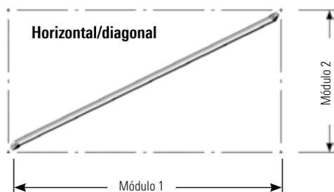
La **Horizontal/diagonal 1**, con cabezas Allround, para el arriostamiento de niveles horizontales en andamios volumétricos sometidos a casos especiales de carga. Es una diagonal en planta.
