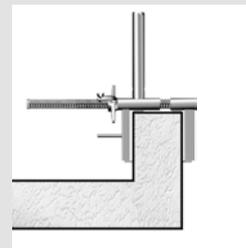
Cuando la mordaza se instala en forjados, se deben colocar rodapiés, y el montante vertical debe ser fijado sobre el eje.
