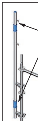
Fig. 36: Conexión del poste de montaje a la barra.
