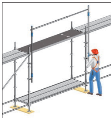
Fig. 38: Detalle del montaje de la barandilla de montaje en el modulo de acceso.
