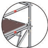
Fig. 84: Unión de verticales con espigas atornilladas
