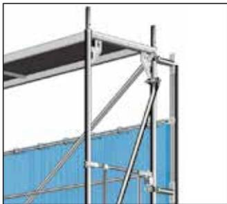
Fig. 130: Ejemplo de montaje de lona Keder
