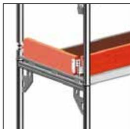
Fig. 35: Colocación del rodapié
