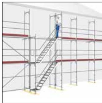
Fig. 66: Instalación de la barandilla
