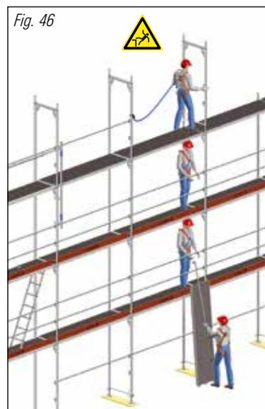
Montar el marco del nivel superior tal y como se muestra. Después del montaje del marco, insertar la barandilla y martillarla firmemente. A continuación, conectar la barandilla lateral e instalar los rodapiés. Los anclajes deben instalarse continuamente a medida que avanza el montaje del andamio.
