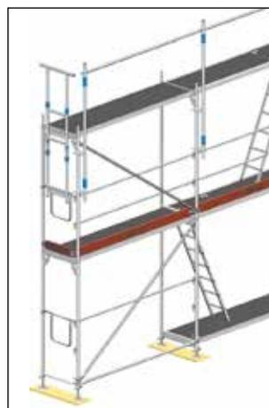
*Fig. 23: Uso de la barandilla de montaje lateral*
